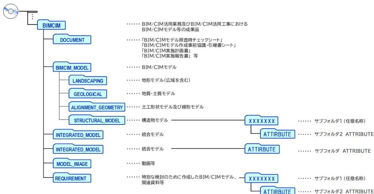
図-4 電子納品対象となる3次元モデル成果物の基本構成
