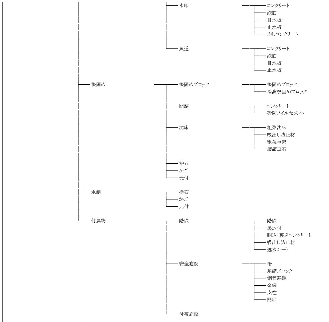
附1-17 砂防構造物・地すべり防止施設(斜面対策工)
